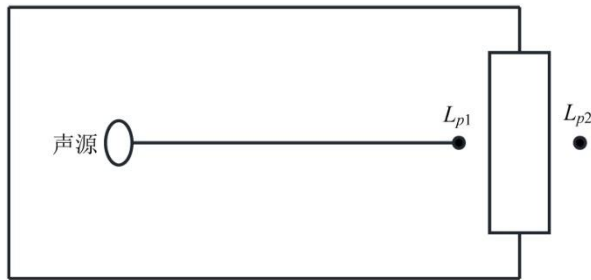
图 4-1 室内声源等效为室外声源图例
